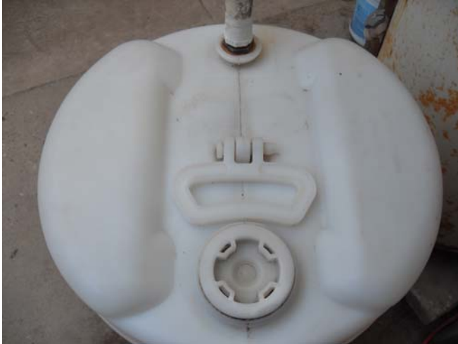
Parte superior del Biodigestor sin gas
