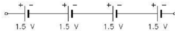
Figura 1 a la izquierda muestra baterías en serie, su voltaje es la suma de los voltajes de cada celda pero su corriente continua igual en todas las baterías, a la derecha su representación esquemática.
