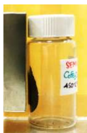
Figura 4.57: Fotografía que demuestra la magnetización del nanomaterial híbrido CFO- \text{TiO}_2 sintetizado por la estrategia semilla, tratado térmicamente.
