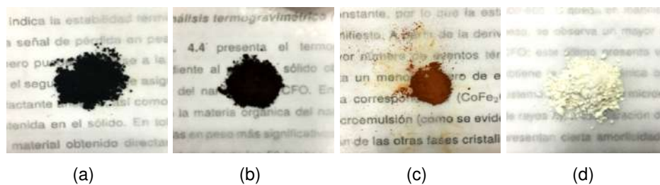
Figura 4.27: Fotografías de los nanomateriales simples sintetizados y tratados térmicamente: (a) CFO, (b) NFO, (c) ZFO y (d) TiO_2
