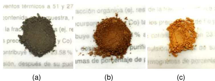
Figura 4.69: Fotografías de los nanomateriales híbridos MFO-TiO 2 05-95 sintetizados y tratados térmicamente: (a) CFO-TiO 2 , (b) NFO-TiO 2 y (c) ZFO-TiO 2 .
