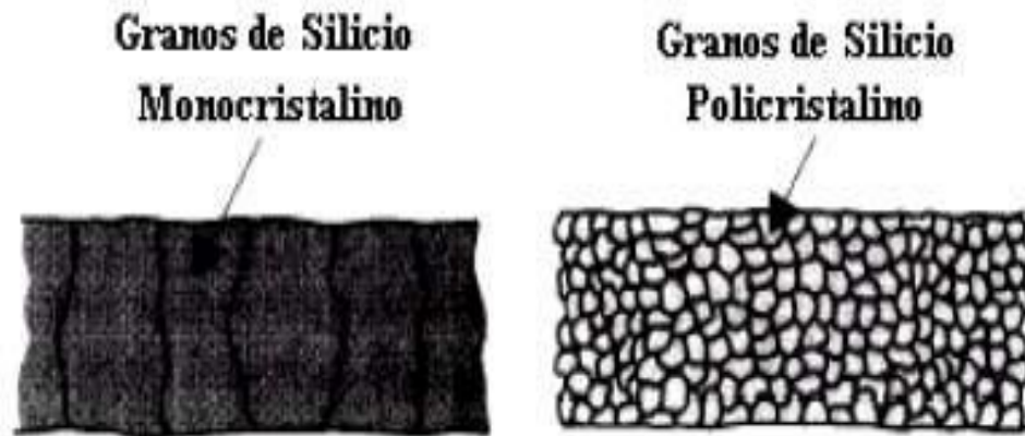
Figura 12. Granos de Silicio Monocristalino y Policristalino ( http://www2.ing.puc.cl , 2016).
