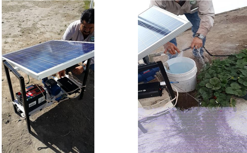
Figura 39. Puesta en marcha del sistema (izq.) y pruebas con carga (der.).
