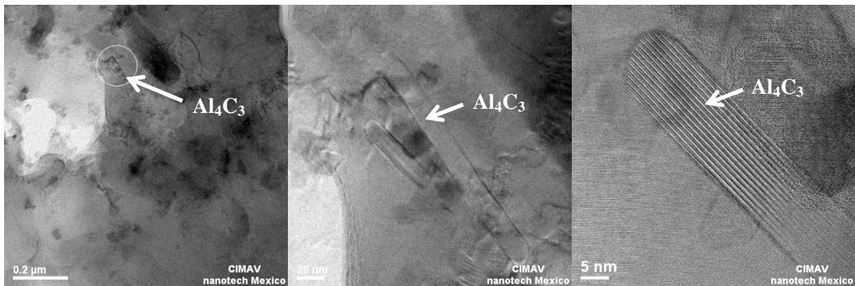
Figura 35. Imágenes de MET en campo claro a diferentes magnificaciones en las que se muestra la presencia del carburo de aluminio ( $Al_4C_3$ ) en la matriz del compósito  $Al_{70}Zn_{1.0}G$  extruido.
