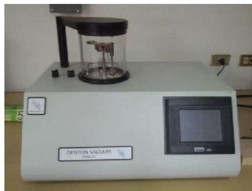
Figura1- 38 Esquema del equipo de erosión catódica con sus componentes y la imagen ilustrativa del equipo.
