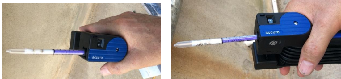
Figura 19. Medición de contaminantes ambientales mediante bomba con el uso de tubos Dräger
