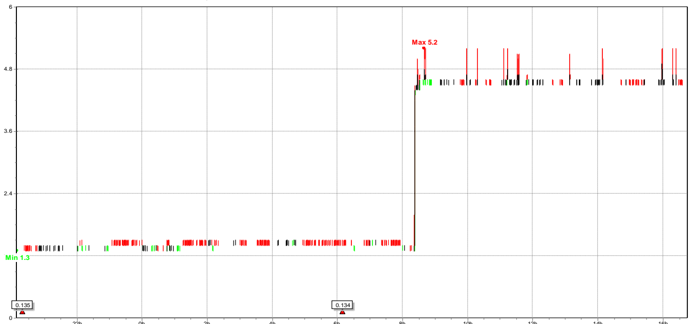
Figura 3.93 Medición de la Potencia Aparente en la Línea 2, a continuación se muestran los valores: máximo de 6.1 KVA , mínimo de 0.1 KVA y promedio de 3.1 KVA .
