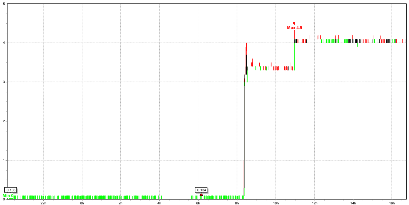
Figura 3.85 Medición de la Potencia Activa en la Línea 2, a continuación se muestran los valores: máximo de 4.5kW , mínimo de 0kW y promedio de 2.25kW .
