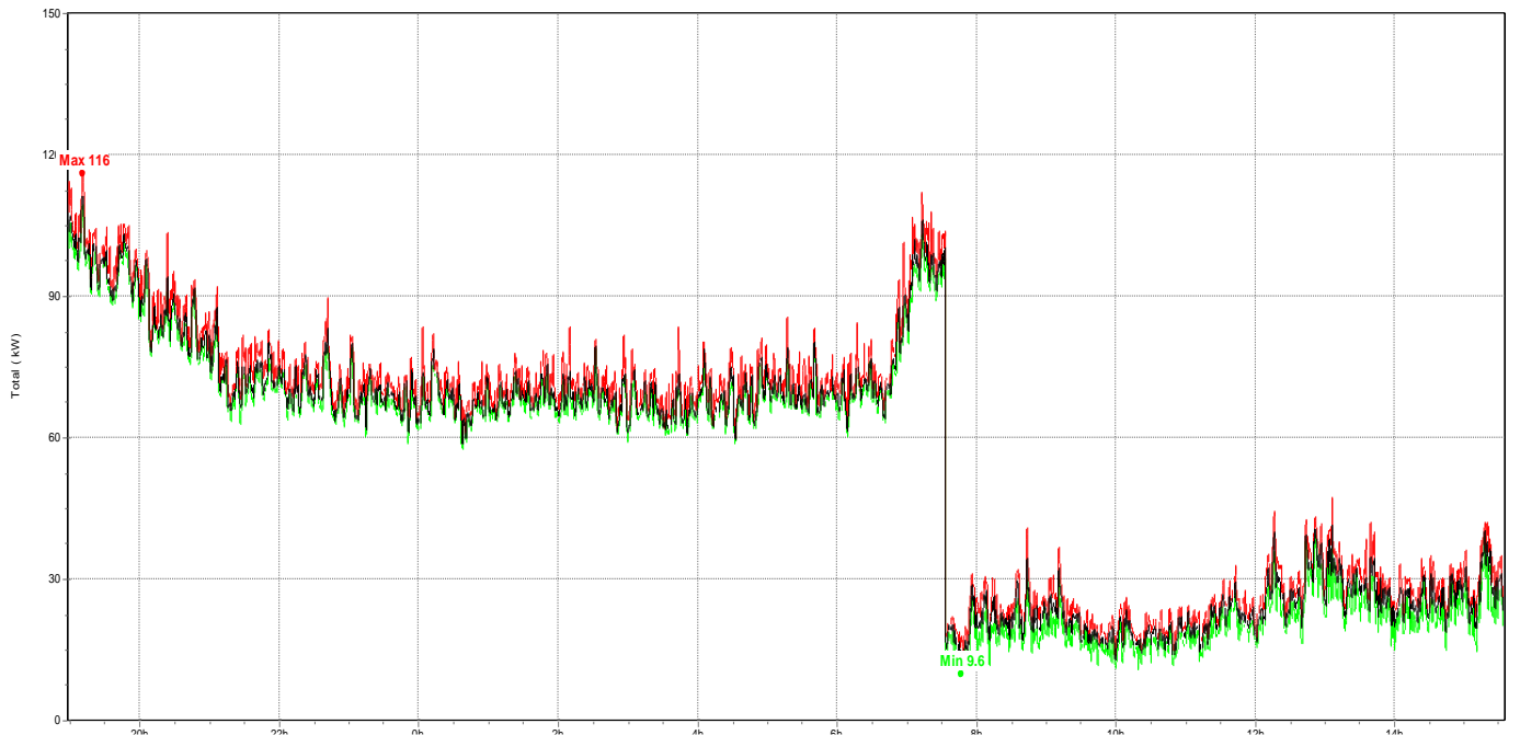
Figura 3.63 Medición de la Potencia Activa en la Línea 3, a continuación se muestran los valores: máximo de 116kW , mínimo de 9.6kW y promedio de 62.8kW .
