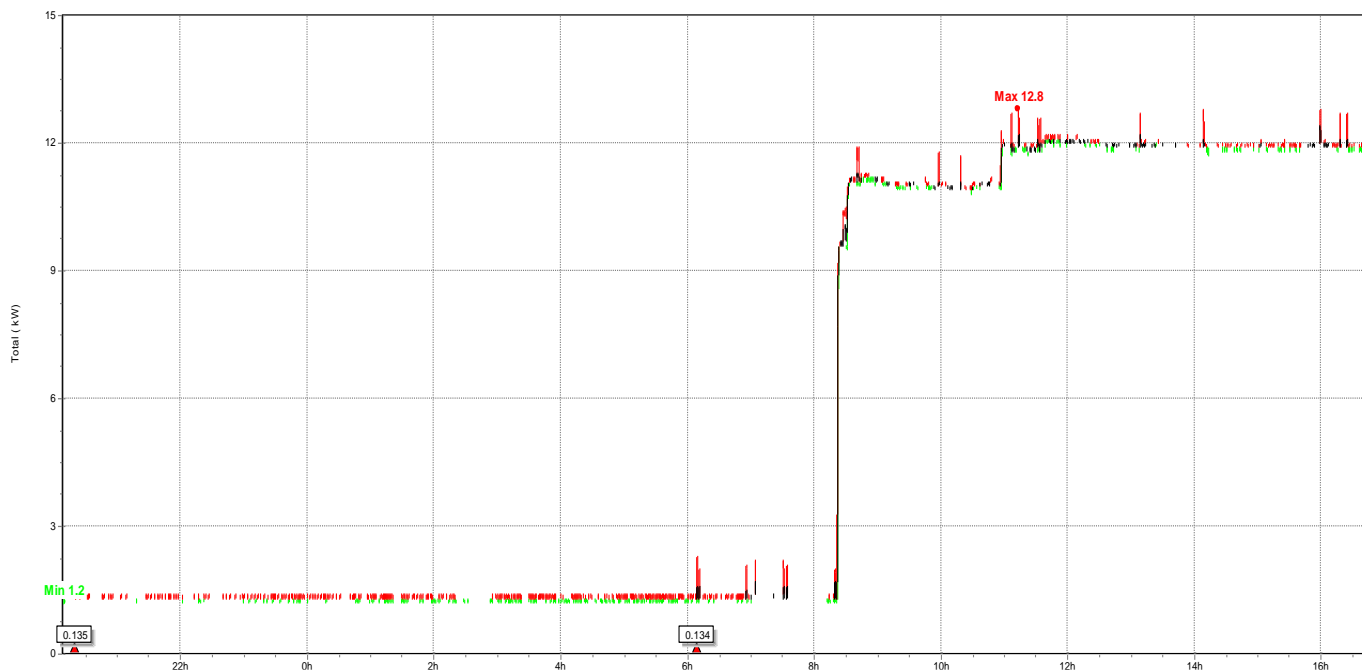
Figura 3.87 Medición de la Potencia Activa en la Línea 3, a continuación se muestran los valores: máximo de 12.8kW , mínimo de 1.2kW y promedio de 7kW .
