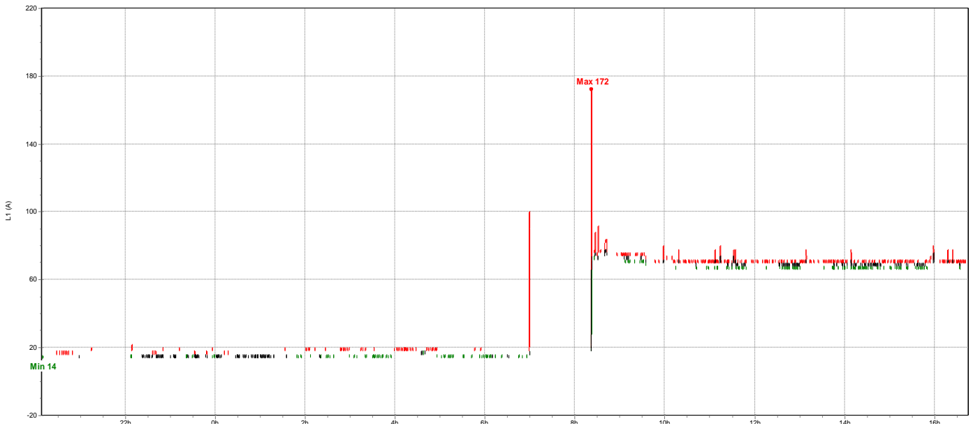
Figura 3.80 Se registró valor máximo de 172 A, mínimo de 14 A y promedio de 93A. En esta gráfica también se aprecia que existen rastros de crestas muy elevadas, puede ser debido al arranque súbito y a plena carga de aparatos de alto consumo.
