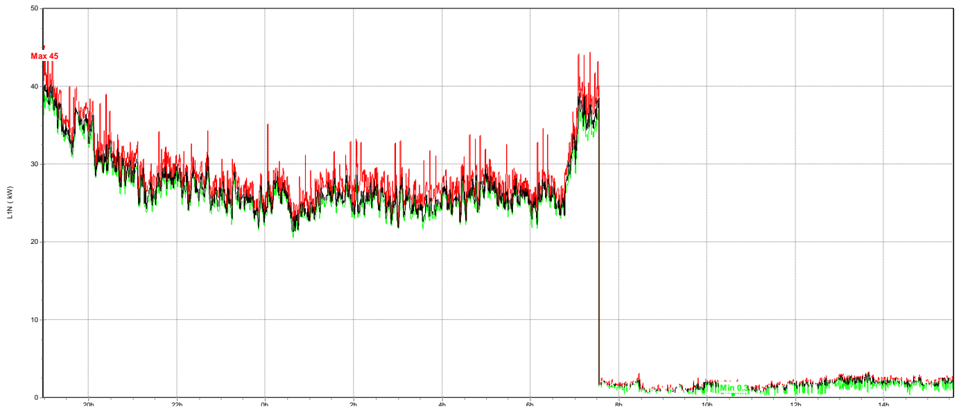
Figura 3.60 Medición de la Potencia Activa en la Línea 1, a continuación se muestran los valores: máximo de 45kW , mínimo de 0.3kW y promedio de 22.65kW .
