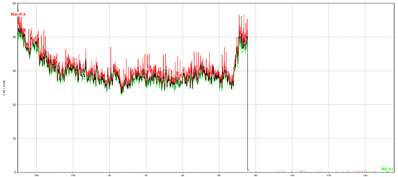
Figura 3.68 Medición de la Potencia Aparente en la Línea 1, a continuación se muestran los valores: máximo de 47.8KVA , mínimo de 0.1 KVA y promedio de 23.95 KVA .
