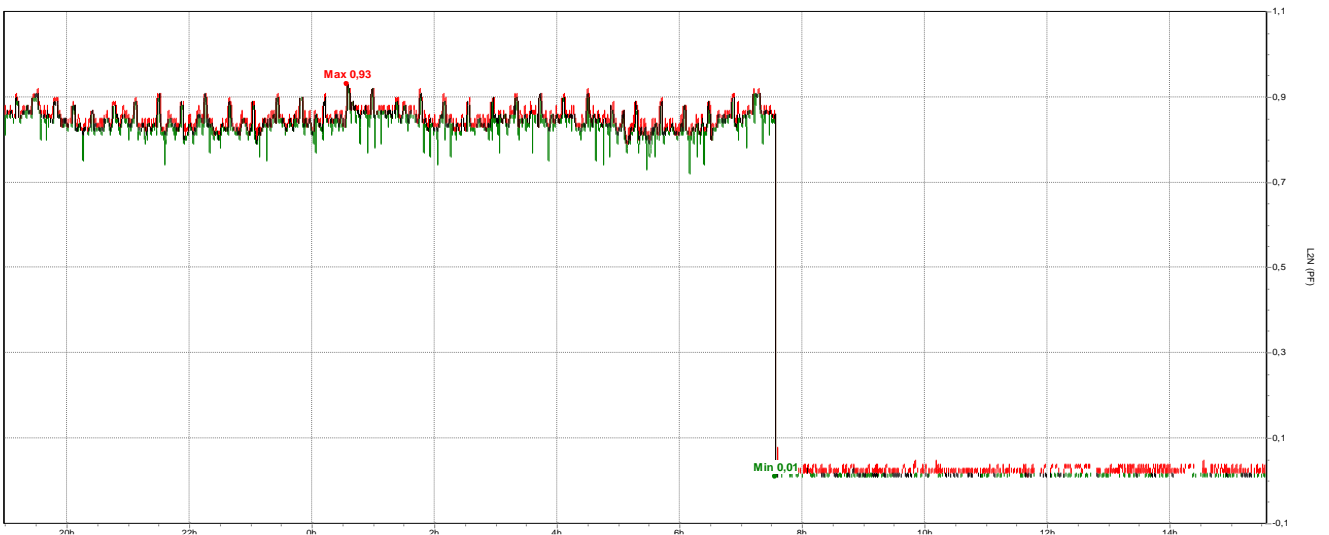
Figura 3.73 Medición del factor de Potencia en la Línea 3, a continuación se muestran los valores: máximo de 0.94 , mínimo de 0.01 y promedio de 0.47 . De acuerdo al historial de consumo del recibo de CFE y a los resultados de este análisis, se puede apreciar que el
