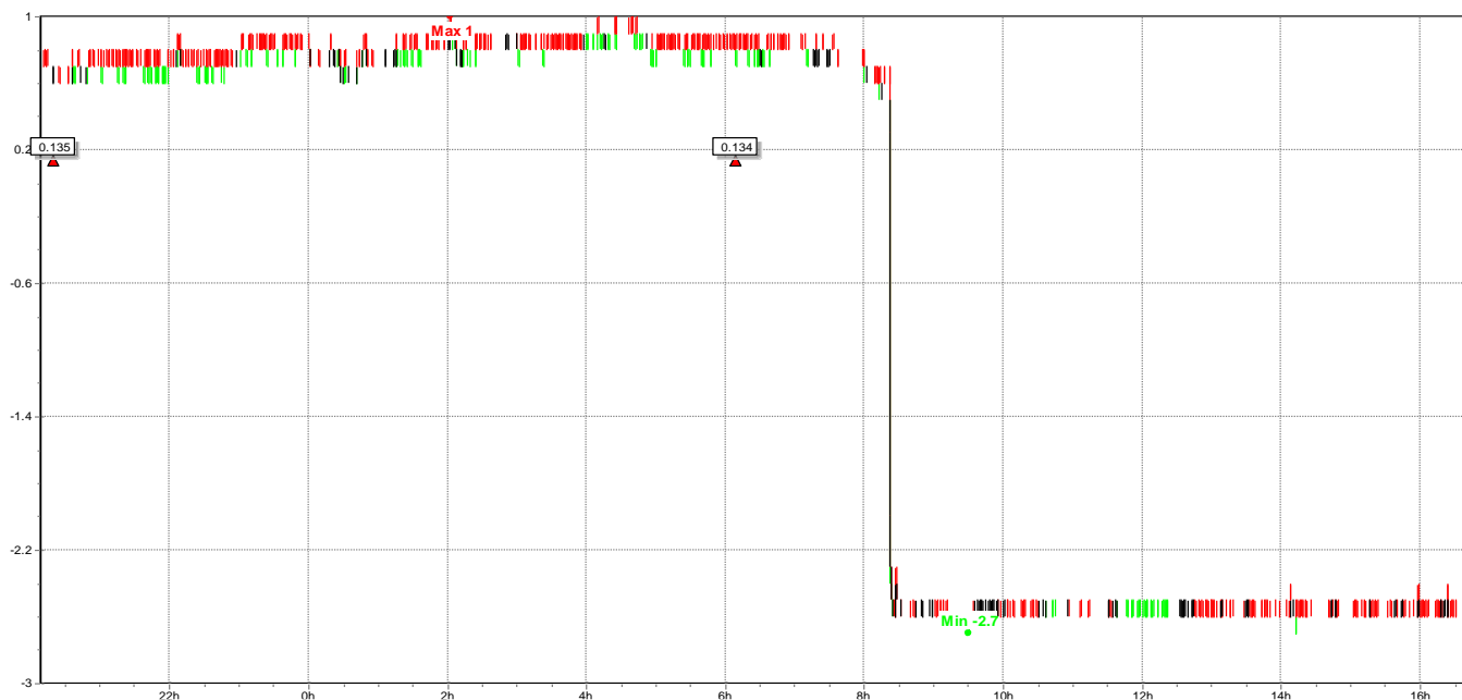
Figura 3.88 Medición de la Potencia Aparente en la Línea 1, a continuación se muestran los valores: máximo de 1 KVAR , mínimo de -2.7 KVAR y promedio de -0.85 KVAR .
