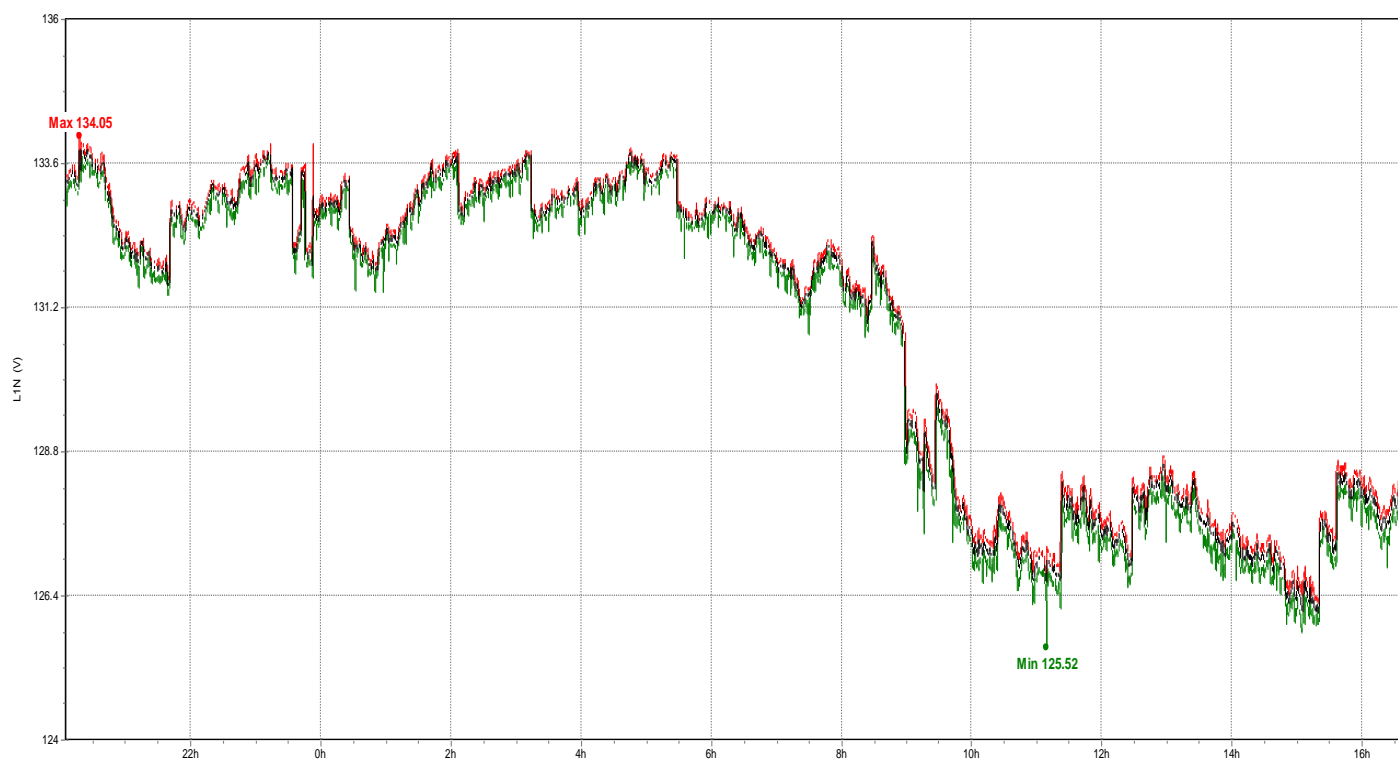
Figura 3.25 Grafico donde se muestra el valor máximo de 134.05V, mínimo de 125.52V. El periodo de muestra fue de 24 horas, la tensión promedio se encuentra 2.19% arriba del valor nominal de 127 Volts, dicha energía proviene del TRO-1 1000 Kva. Para los valores recomendados por el estándar IEEE 1100-1999, el valor no debe ser mayor al 5% del valor nominal. Existe una relación clara de cuando el voltaje de la red baja es debido al aumento de equipos encendidos.
