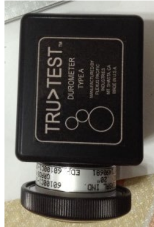
Figura 9. Durómetro marca Tru-Test, escala Shore tipo A.
