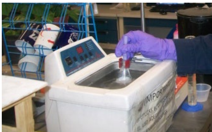
Figura 10. Proceso de sonificación de la muestra para la prueba del HRTEM.
