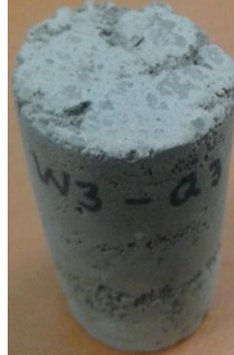
Figura 22. Mortero con proceso de hidratación deficiente
