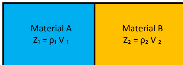
Figura 4.3 sistema compuesto por dos barras de materiales con propiedades acústicas diferentes.
