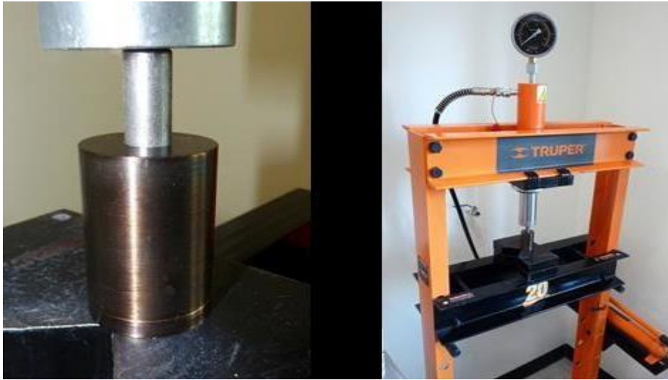
Figura 3.1. Imágenes del dado y la prensa utilizados en el prensado en caliente.
