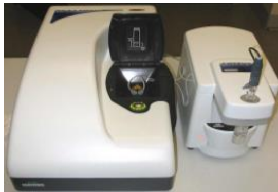
Figura 9. Fotografía del equipo Zeta sizer/MPT-Z.
