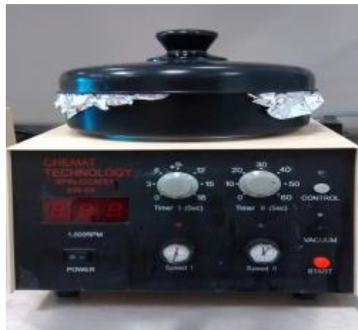
Figura 7. Fotografía del equipo de moldeo por centrifugación.
