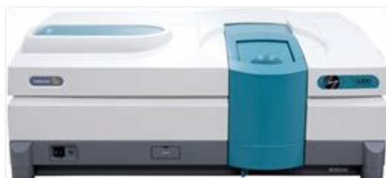
Figura 10. Fotografía del equipo UV-Vis-NIR Cary 5000 (Varian).
