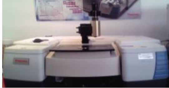
Figura 11. Fotografía del equipo is50FT-IR (Nicolet).
