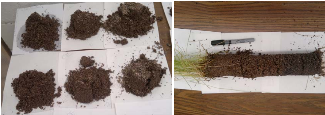
Figura 32. Fraccionamiento de los cilindros de suelo de HC y muestra de suelo/planta de HA.
