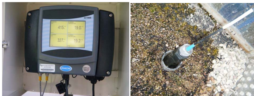
Figura 29. Equipo y sonda para monitoreo de Eh.
