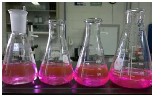
Figura 22. Diluciones de Rodamina B para gráfica absorbancia-concentración.
