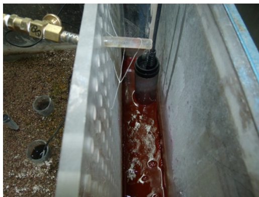
Figura 26. Rodamina WT a la entrada de HC.
