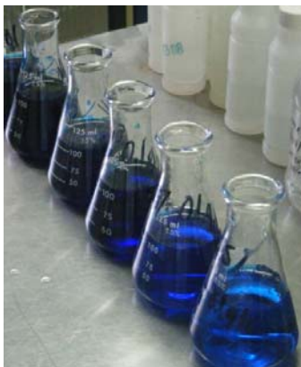
Figura 20. Diluciones de azul de metileno para gráfica absorbancia-concentración.
