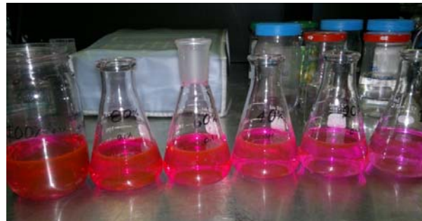
Figura 24. Diluciones de Rodamina WT para gráfica absorbancia-concentración
