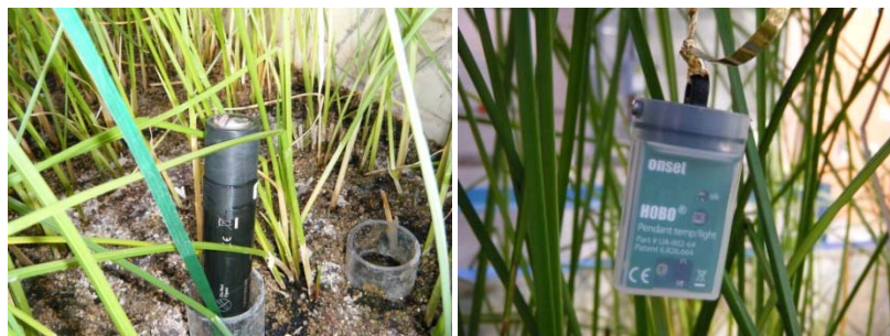
Figura 30. Sonda de monitoreo de conductividad/temperatura del agua y sensor de medición de intensidad de luz/temperatura ambiente.
