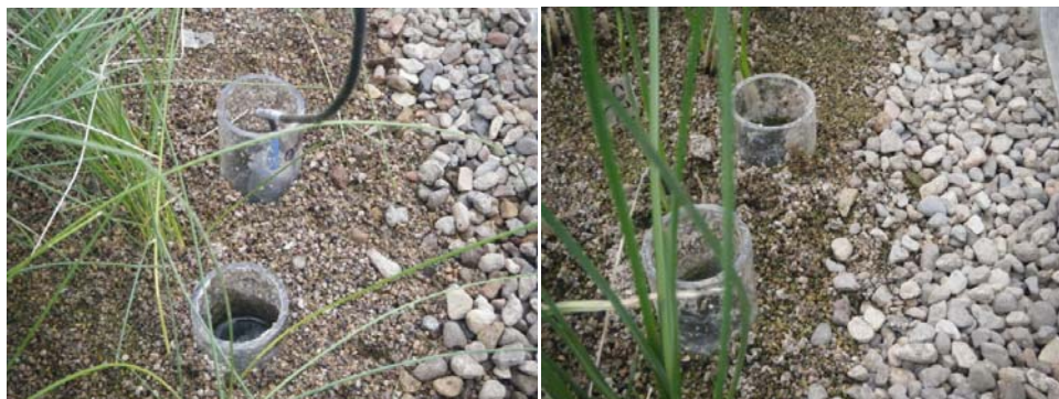
Figura 28. Pozos de monitoreo de parámetros en HA y HB.
