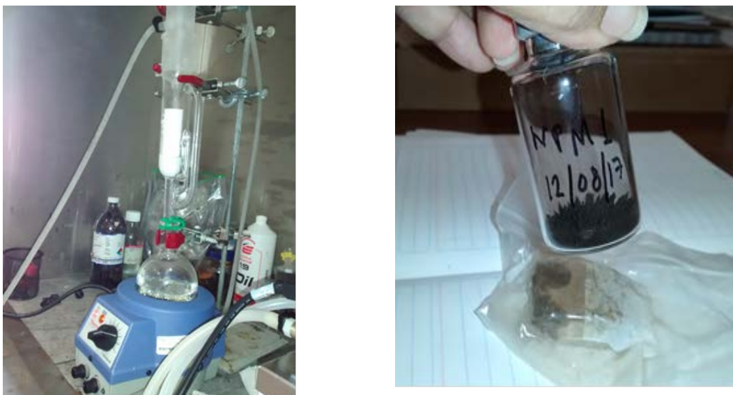
Figura 10. Izquierda) Método de purificación por sistema Soxhlet; derecha) NPMs obtenidas y su almacenamiento bajo atmósfera inerte.
