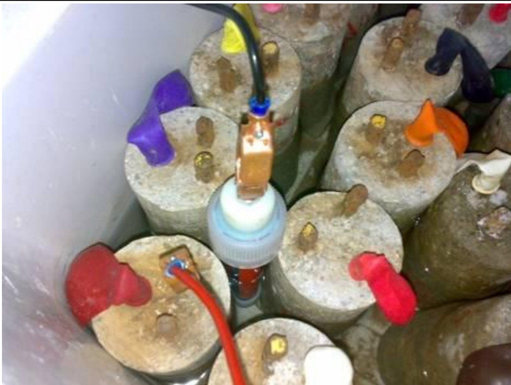
Figura 2.12 Medición del Potencial, con el electrodo de referencia.
