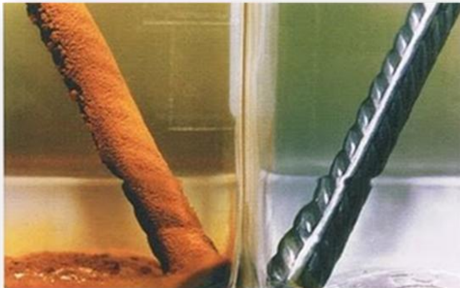
Figura 2.10 Acero pre oxidado y acero limpio(normal)
