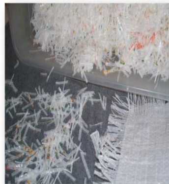
Figura 2.4 Deshilado y corte del costal
