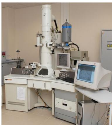
Figura 2.7: microscopio electrónico de transmisión marca JEOL modelo JEM2010
