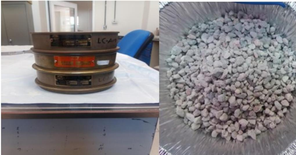
*Figura 10 - Tamices usados y zeolitas de tamaño 4-2 mm.*
