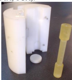
Figura 1. Ejemplo de molde de teflón para probetas a tensión.
