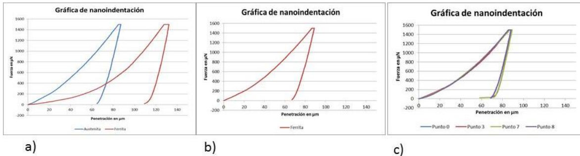
Figura 14. Comportamiento de la prueba de nanoindentación y valores de módulo de rigidez para: a) metal base, b) soldadura y c) grieta
