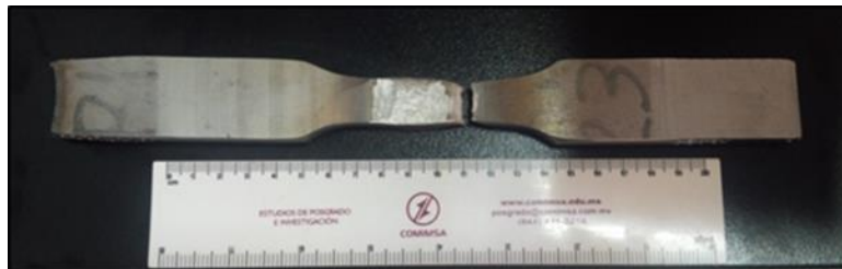
Figura 1. Ejemplar de probeta de tensión de donde se extrajeron las muestras para la caracterización
