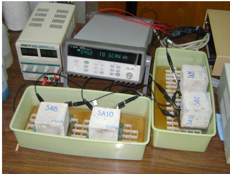
Figura 4.2. Montaje de la Extracción en morteros cúbicos.
