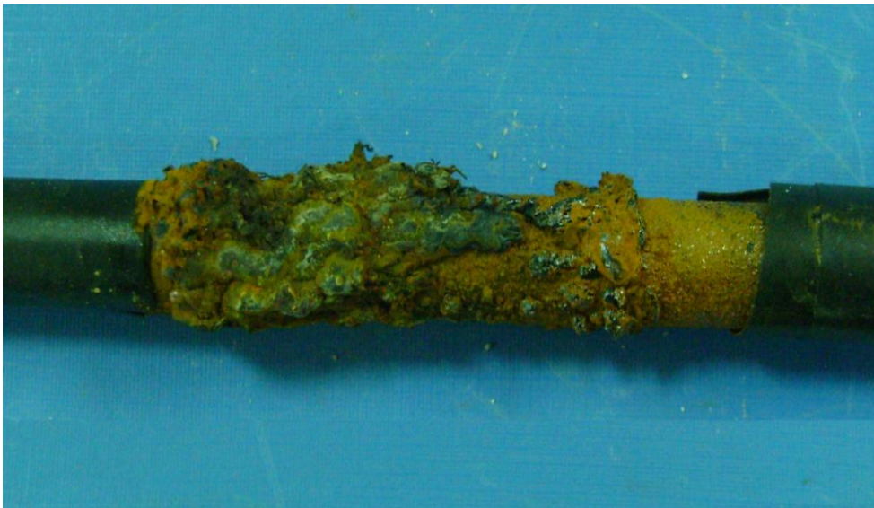
Figura 4.12. Varilla de acero altamente corrida en una solución de NaCl.
