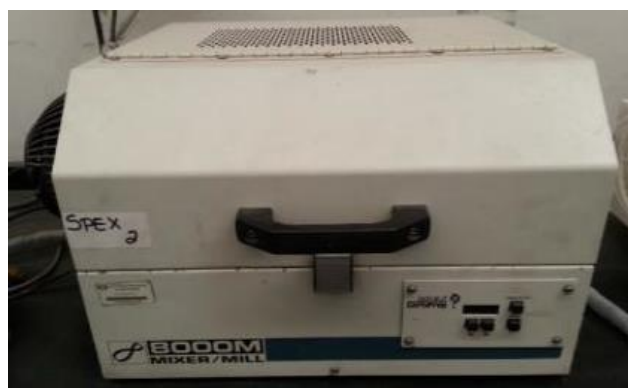
Figura 9. Molino de alta energía tipo SPEX 8000M utilizado para la molienda mecánica.
