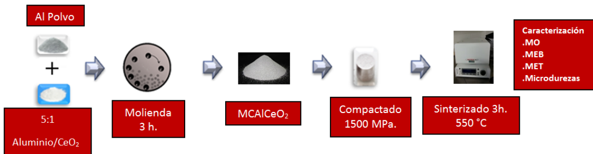
Figura 11. Síntesis del material compuesto de CeO 2 disperso en aluminio puro.
