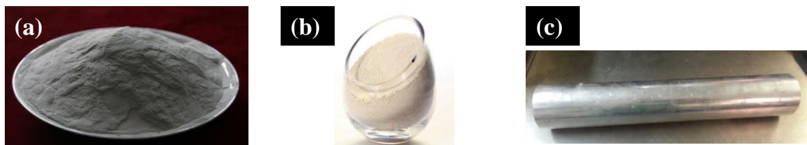
Figura 8. Materia prima empleada para la fabricación de las aleaciones de estudio: a) aluminio en polvo, b) nanopartículas de \text{CeO}_2 y c) aleación comercial A2024 en barra.
