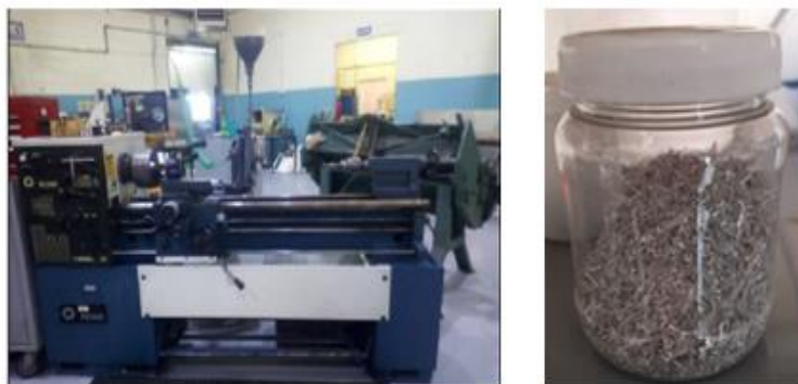
Figura 20 Torno paralelo y rebaba metálica de Al-7075.
