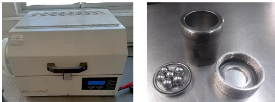
Figura 21 Molino Spex y vial con bolas de acero.
