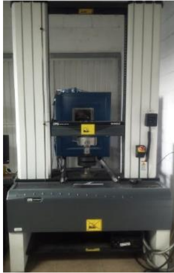
Figura 10 Máquina Universal INSTRON 100 kN modelo 3382.
