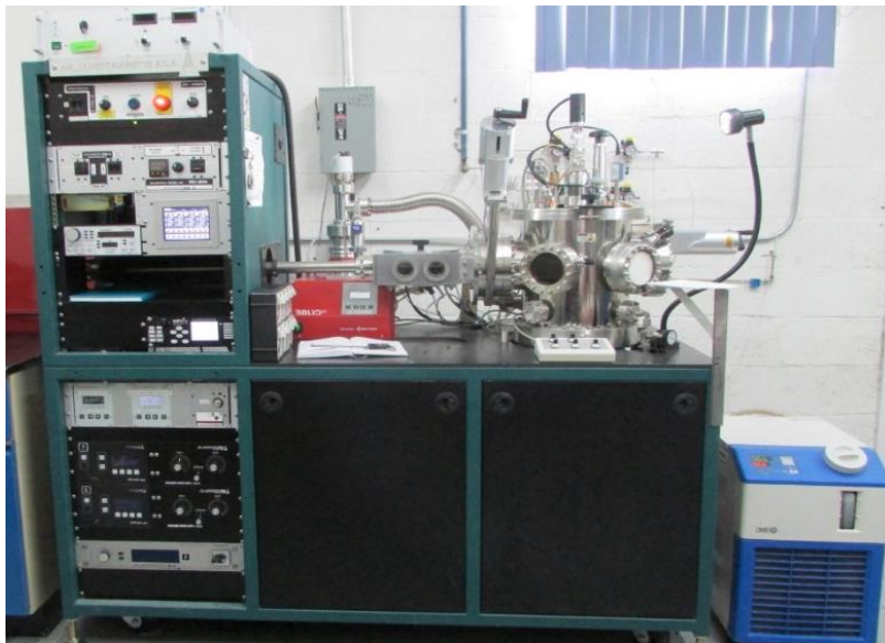
Figure 9. Sistema de pulverización catódica (sputtering).
