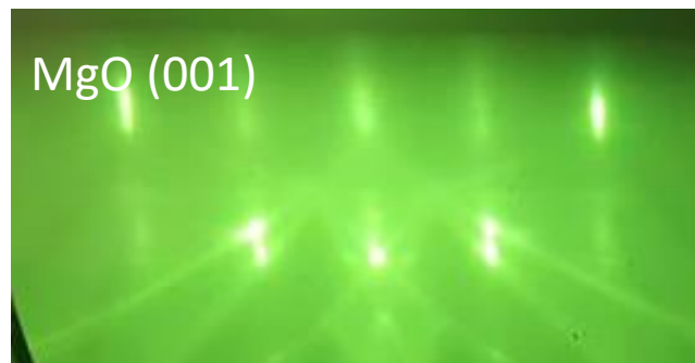
Figura 16. Patrón de RHEED de sustrato de \text{MgO} .
