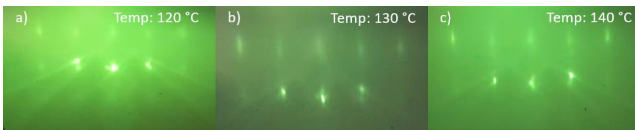
Figura 17. Patrones de difracción de películas delgadas crecidas a diferentes temperaturas.
