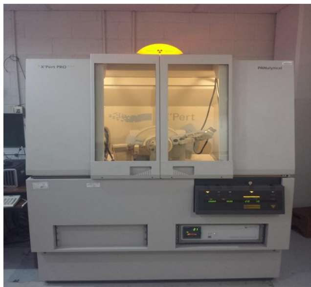
Figura 13. Instrumento de rayos X Panalytical –modelo X'Pert PRO MPD con detector X'Celerator.
