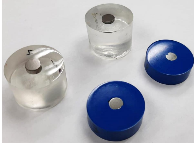
Figura 16. Muestras montadas en resina y bakelita.
