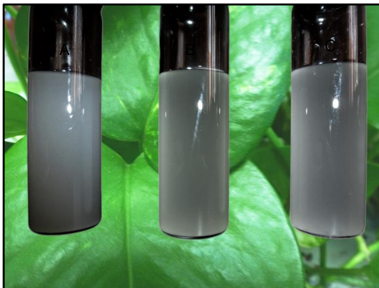
Figura 19. Dispersión de partículas poliméricas en diversos solventes. A) THF, B) DMF, C) Lactato de etilo.
