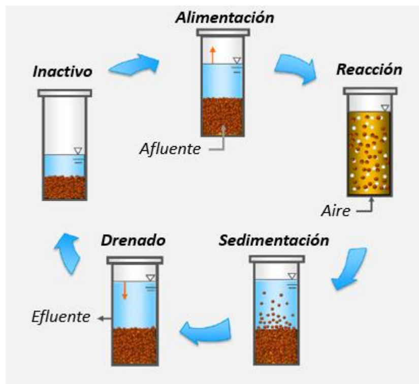
Figura 12. Diagrama de operación de un reactor discontinuo secuencial (SBR por sus siglas en inglés) para granulación aerobia.
