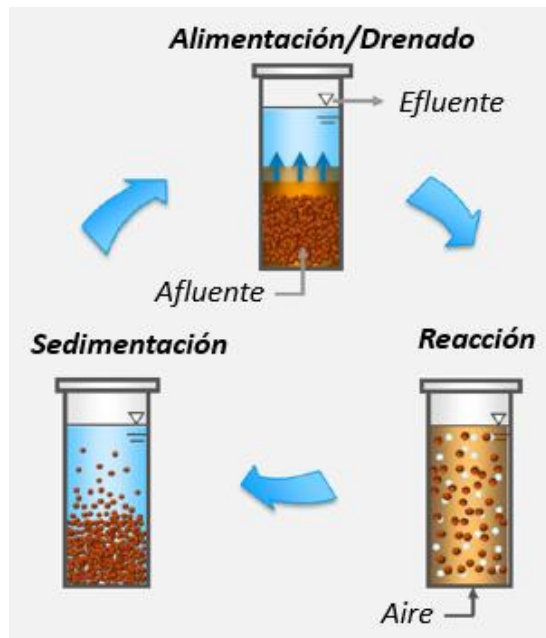
Figura 13. Diagrama de operación de un reactor Nereda
