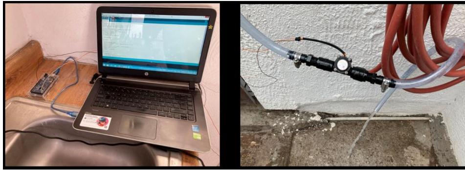
Figura 26. Izq. Computadora recibiendo información del sensor de flujo. Der. Agua fluyendo a través del sensor
