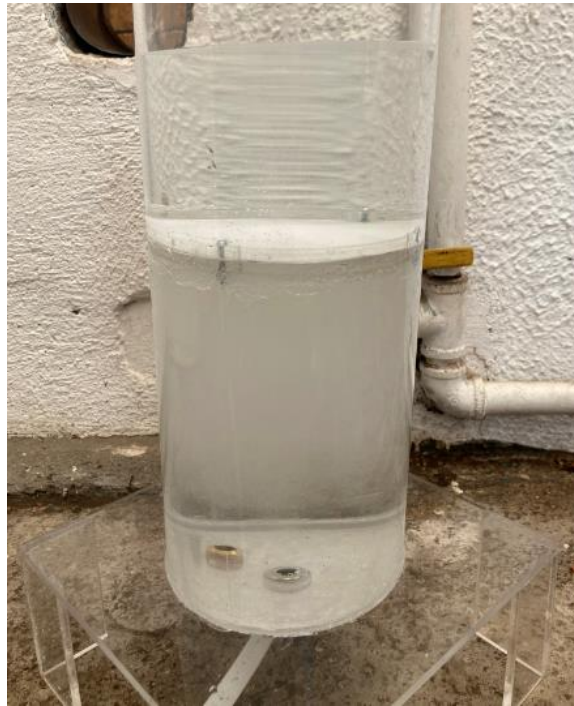
Figura 49. Fotografía del reactor durante prueba de permeado utilizando agua de red de distribución doméstica
