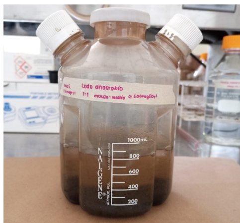
Figura 6. Representación del recipiente que contiene el lodo para la activación de bacterias sulfato reductoras.
