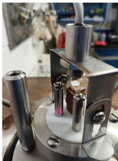
Figura 4. El ensamblado de los recubrimientos en la cámara de sensado de gases.
