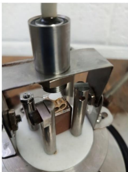
Figura 4. El ensamblado de los recubrimientos en la cámara de sensado de gases.
