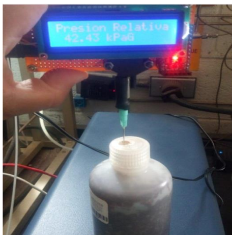
Figura 31.- (a) Medidor de presión por medio de sensor. (b) equipo de cromatografía INFICON micro GC fusión.
