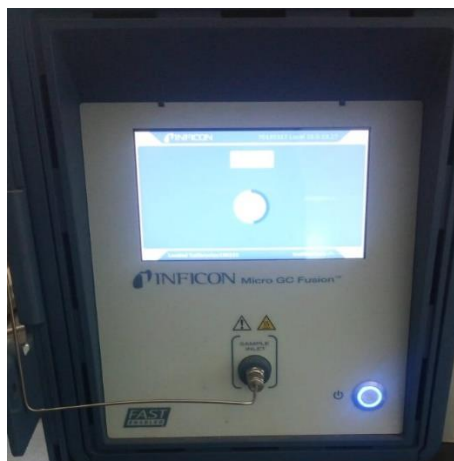
Figura 31.- (a) Medidor de presión por medio de sensor. (b) equipo de cromatografía INFICON micro GC fusión.
