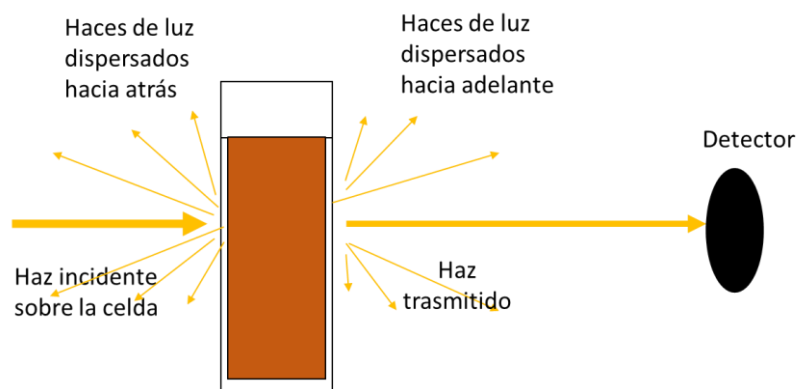
Figura 23. Configuración utilizada para la medición del coeficiente de extinción \beta_\lambda . El haz de luz incidente sobre la suspensión en la celda, es en parte absorbido y dispersado, por lo al alcanzar el detector la medición de la pérdida de la intensidad representa la suma de los coeficientes de absorción y dispersión.
