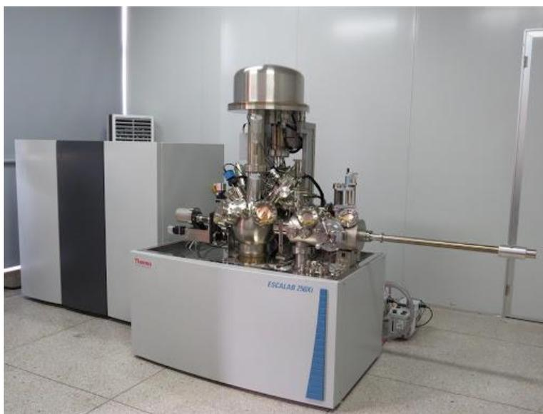
**Figura 18.** Equipo XPS ESCALAB 250Xi Thermoscientific™, CIMAV-Monterrey, S.C.
