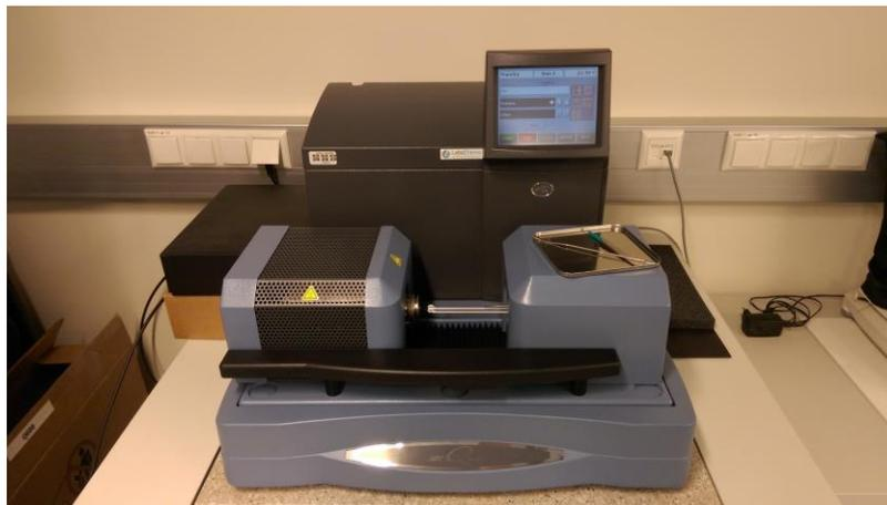
**Figura 12.** Analizador térmico STD Q600 TA Instruments, CIMAV, Chihuahua.
