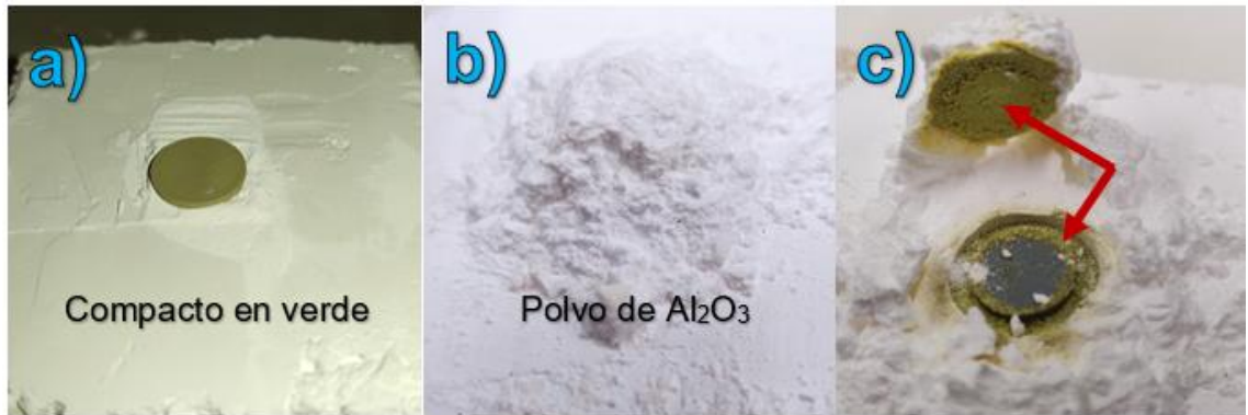
Figura 3.18. a) Fotografía del compacto en verde, b) Polvo de \text{Al}_2\text{O}_3 como cama que cubre el compacto en verde, y c) Interacción del \text{Bi}_2\text{O}_3 y la cama de polvo de alúmina (flechas rojas) después de sinterizar a 890 °C durante 61h.
