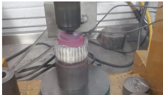
Figura 13: Conformado asistido por inducción magnética.
