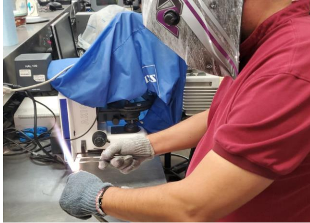
Figura 15: Sellado de tubos de cuarzo luego de vacío.
