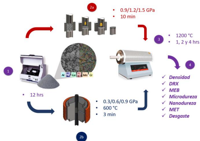
Figura 12: Metodología experimental propuesta: 1) aleado mecánico de los polvos, 2a) ruta de conformado convencional, 2b) conformado asistido por inducción, 3) sinterizado y 4) caracterización.
