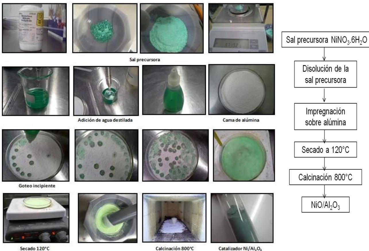
Figura 8. Procedimiento para la síntesis del catalizador Ni/Al 2 O 3 .
