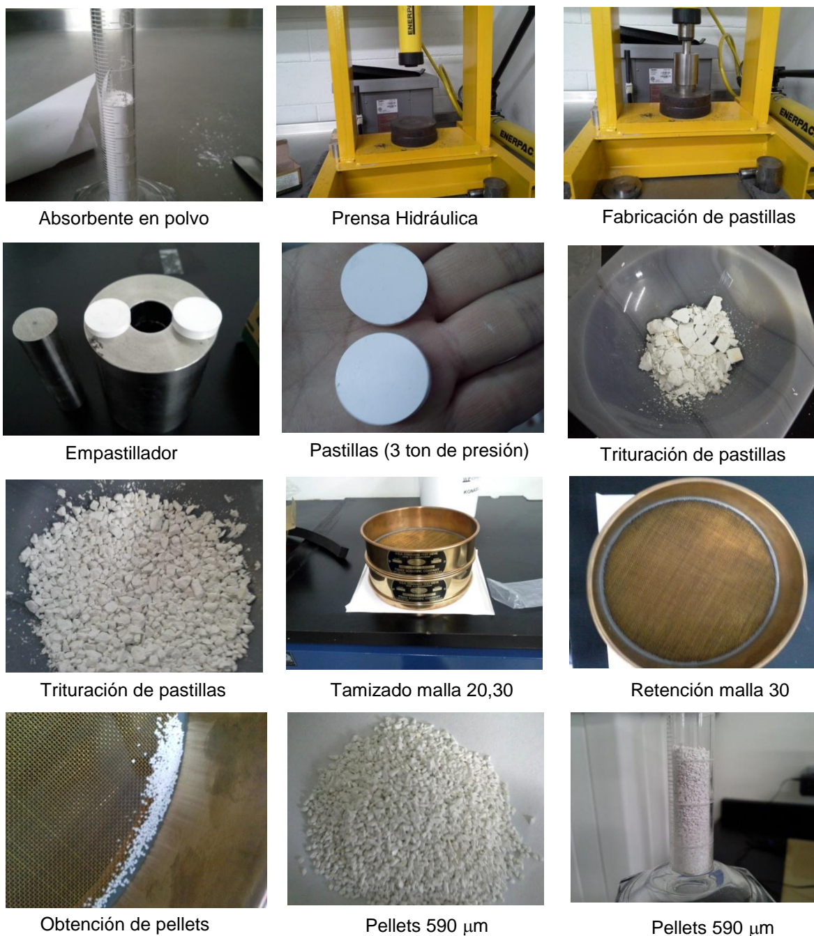
Figura 10. Fabricación de pellets ( 590\ \mu\text{m} ) de absorbentes.
