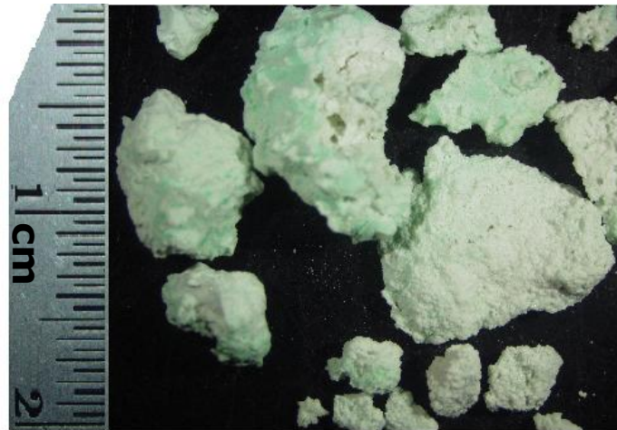
Figura 3.62 Fotografía Digital de los adsorbentes saturados en los experimentos de adsorción de Ni. El tiempo de contacto fue de 7 horas. Experimento de tipo estático.
