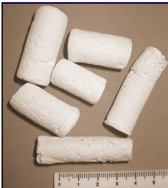
Figura 3.25. Fotografía digital de los cilindros de 43.5% PTK, 6.25% de vidrio pyrex y 50% de almidón de papa, las muestras fueron sinterizados a 1100° C.
