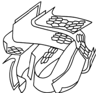
Figura 1.3. Esquema de la microestructura de un carbón activado (Harry Marsh y Francisco Rodríguez Reynoso en Activated carbón, Ed. Elsevier 2006.)
