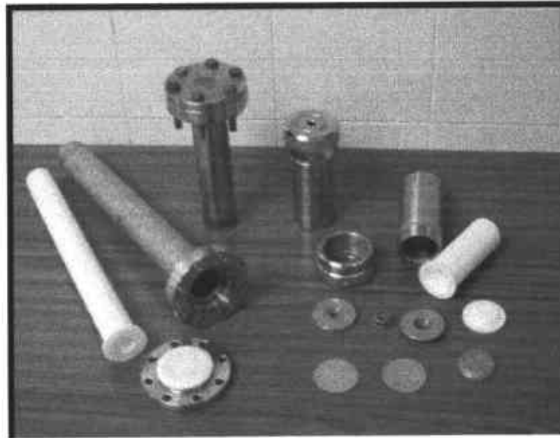
Figura 2.4 Autoclaves de acero inoxidable con recipientes de teflón.
