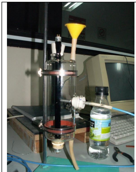
Figura 17. Prototipo COVI para medición de intensidades.
