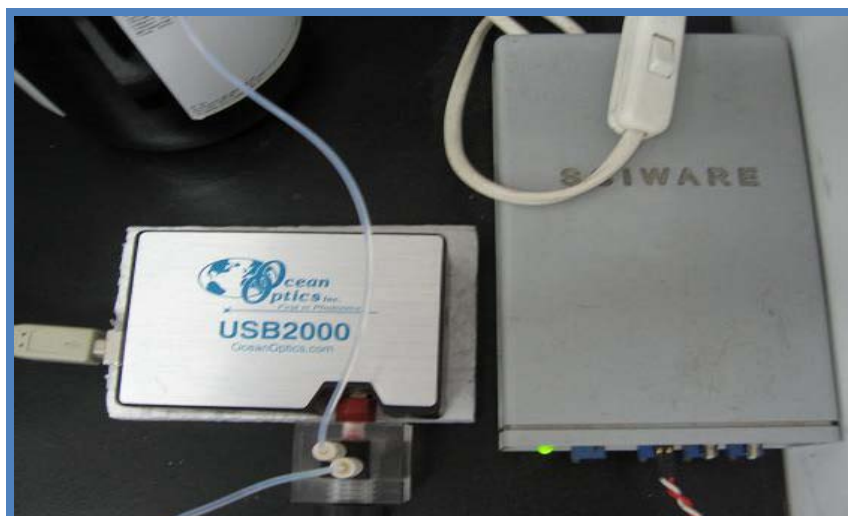
Figura 15. Sistema de detección espectrofotométrica, constituido por un espectrofotómetro CCD (USB 2000, Ocean Optics) y un cabezal de diodos LED alimentado por una fuente de intensidad.
