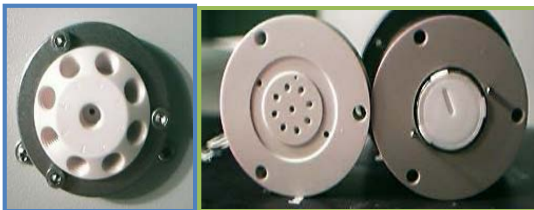
Figura 12. Detalle de la válvula de selección utilizada en SIA. A la derecha se muestra desmontada para poder apreciar su configuración.
