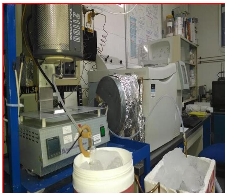
Figura 12. Equipo del laboratorio utilizado para la pirolisis de la pomasa de manzana
