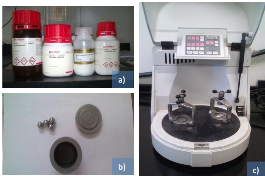
Fig. 4.2. a) Los compuestos precursores Mn_2O_3 , SrCO_3 , CaCO_3 y La_2O_3 , b) Uno de los viales de acero inoxidable y las bolas de acero endurecido de grado industrial. c) Molino planetario de baja energía Pulverisette 7.
