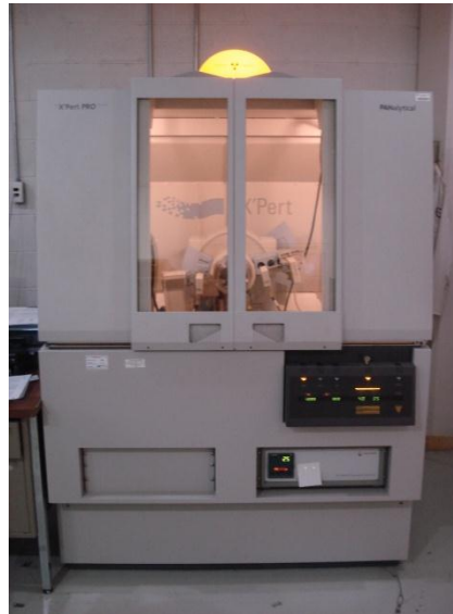
Fig. 4.4. Difractómetro de la marca Panalytical modelo X'PertPro-MPD utilizado en las mediciones de la presente investigación.
