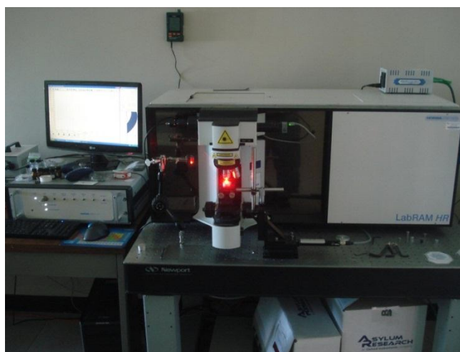
Fig. 4.7. Espectrómetro Raman marca Horiba modelo LabRam HR VIS 633 usado en el presente proyecto.
