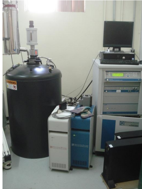
Fig. 4.8. Sistema PPMS con magnetómetro de muestra vibrante (MMV).
