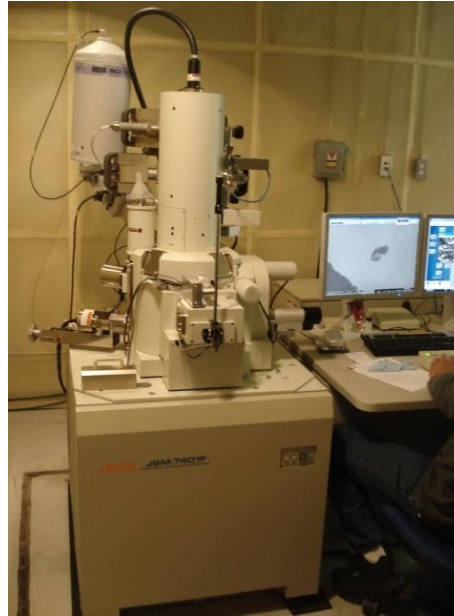
Fig. 4.5. Microscopio electrónico de barrido marca JEOL modelo JSM-7401F con analizador EDAX marca Oxford modelo INCA Penta FETX3 utilizados en la caracterización para este proyecto.
