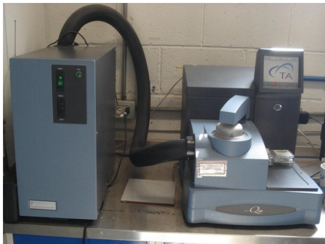
Fig. 4.6. Calorímetro Diferencial de Barrido de la marca TA Instruments modelo DSC Q200. utilizado en el presente proyecto.
