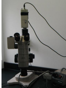
Figura 5. Microscopio Óptico Image-Proplus, Olympus SZH10 con lente 1X.5
