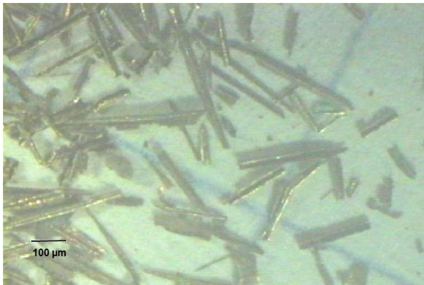
Figura 11. Muestra C, limaduras de bronce resultado de tamizado con malla tamaño 50.
