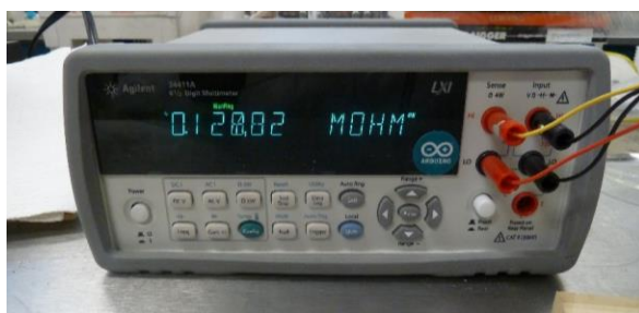
Figura 6. multímetro Digital de cuatro puntas, marca Agilent LX1 modelo 34411A
