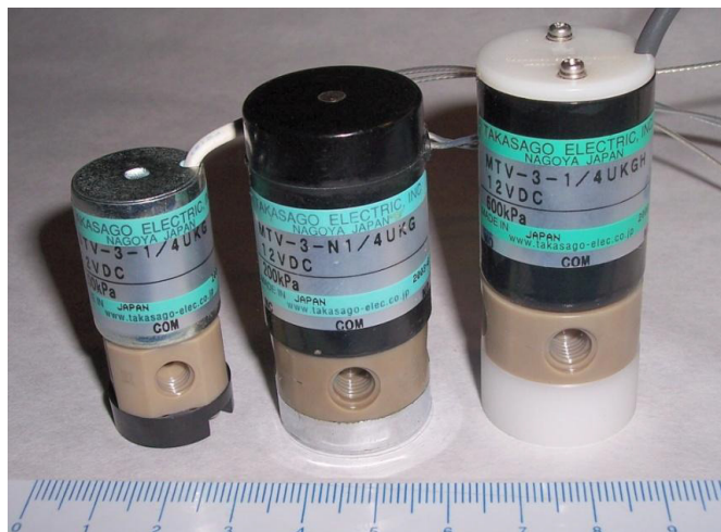
Figura 4.7. Válvulas solenoides de multiconmutación externa (Takasago Electronic Inc.) usadas para direccionar el fluido.
