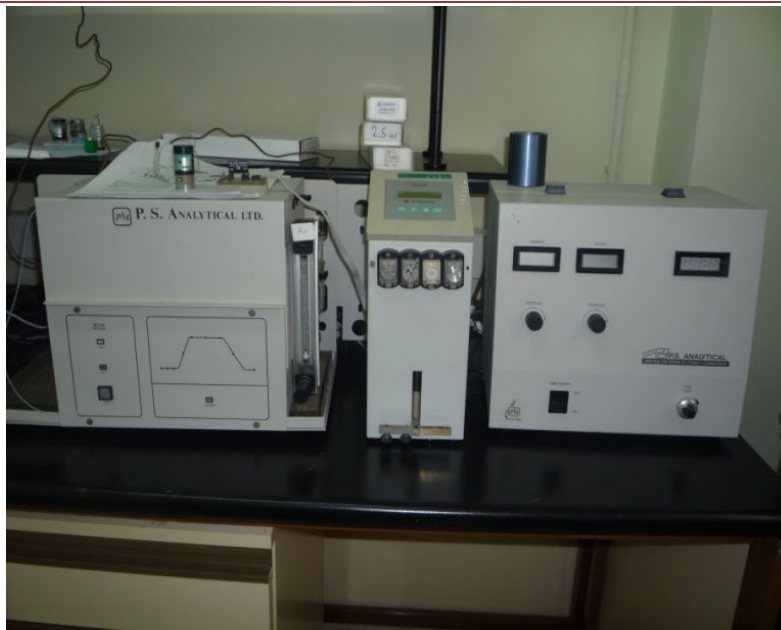
Figura. 4.1 Equipo de fluorescencia atómica y el sistema MSFIA aun sin realizársele el montaje para la determinación de arsénico.
