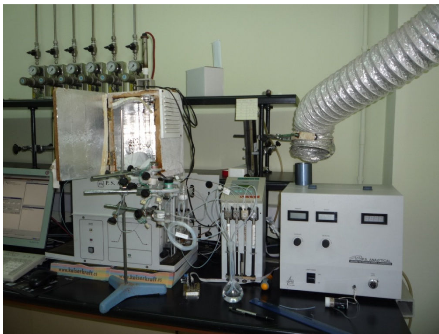
Figura.4.4 Imagen del equipo montado en su totalidad con el fotorreactor conectado al sistema de detección.
