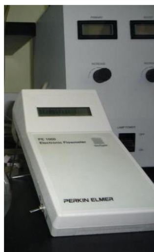
Figura 5.5 Caudalímetro para el ajuste de flujos de gases utilizados en el equipo.
