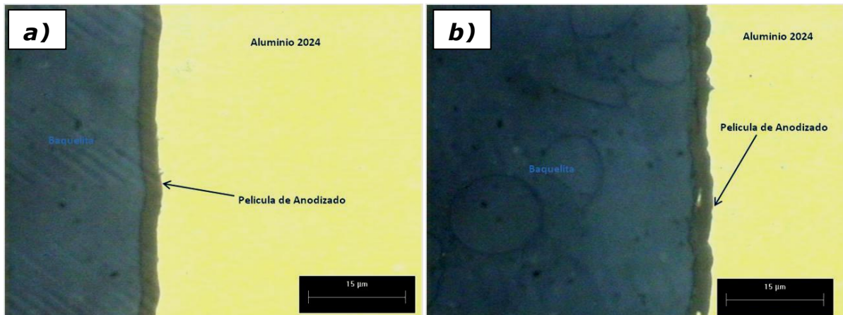
Figura 6. Imagen por microscopio óptico de películas de oxido de muestras anodizadas a 15°C, 20 volts y a) 2% en peso de H_3BO_3 , b) 3% en peso de H_3BO_3 .
