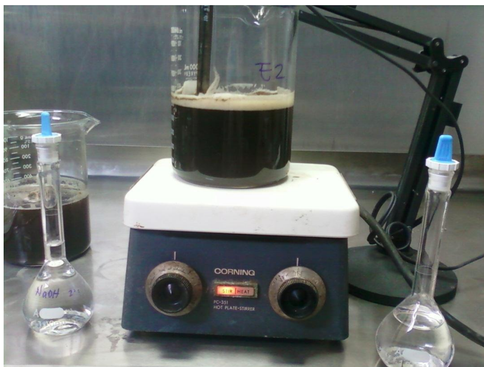
Figura 16. Sistema de oxidación química
