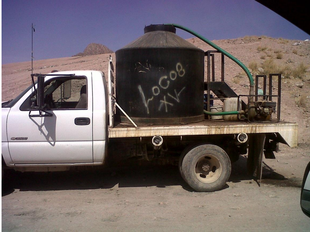
Figura 6. Vehículo para la recirculación de lixiviados
