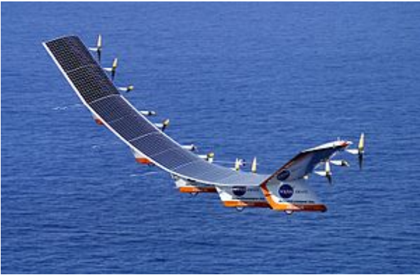
Fig. 2 Imagen del prototipo Helios , avión no tripulado de la NASA propulsado mediante energía solar fotovoltaica.
