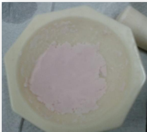
Figura 20. Mezcla final de la impregnación del cobalto.
