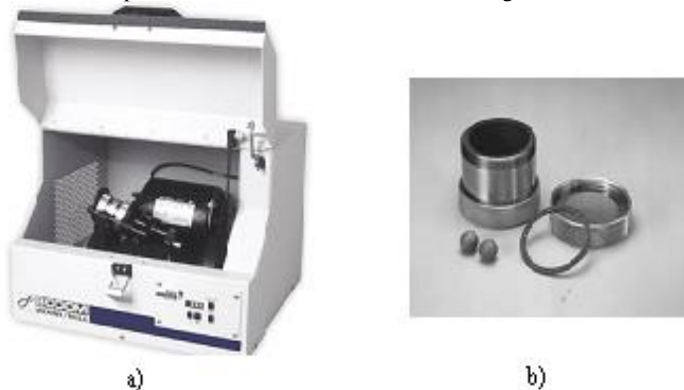
Figura 8. Molino agitador SPEX 800, a) En condición de ensamblado y b) Contenedor de WC y medio de molienda (bolas)
