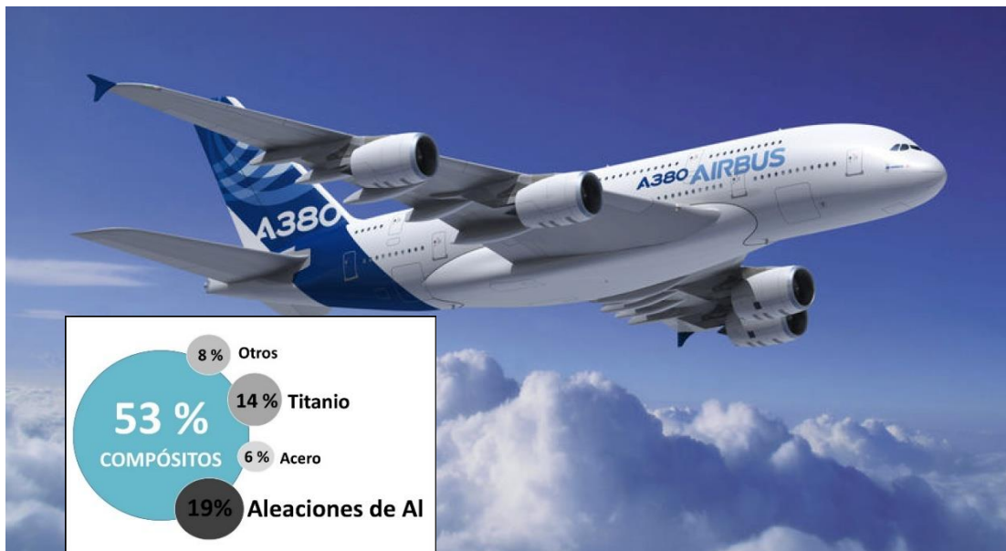
Figura 1. Materiales comúnmente empleados en el cuerpo de una aeronave moderna.
