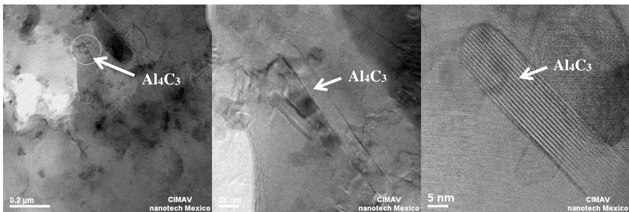
Figura 32. Imágenes de MET en campo claro del compósito \text{Al}_{7075} 5\text{Zn}1.0\text{G} extruido, en ellas se muestra la fase \text{Al}_4\text{C}_3 .
