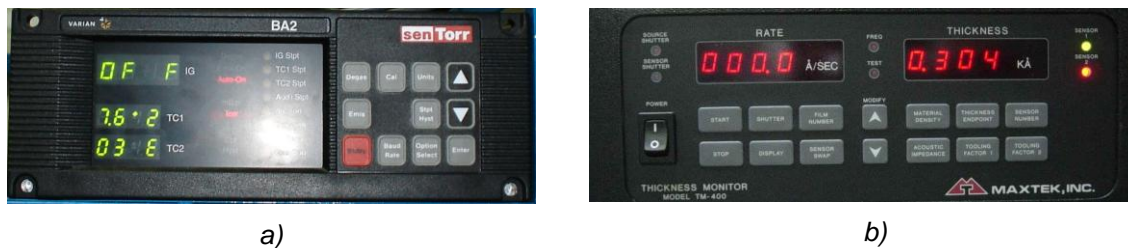
Figura 3.3. a) Medidor con sensor termopar para medir el vacío. b) Sistema de medición de espesores y razón de depósito.
