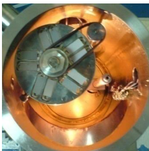
Figura 3.4. Carrusel giratorio de 10 portasustratos, en él se pueden depositar hasta cinco espesores distintos en una misma sesión de vacío.
