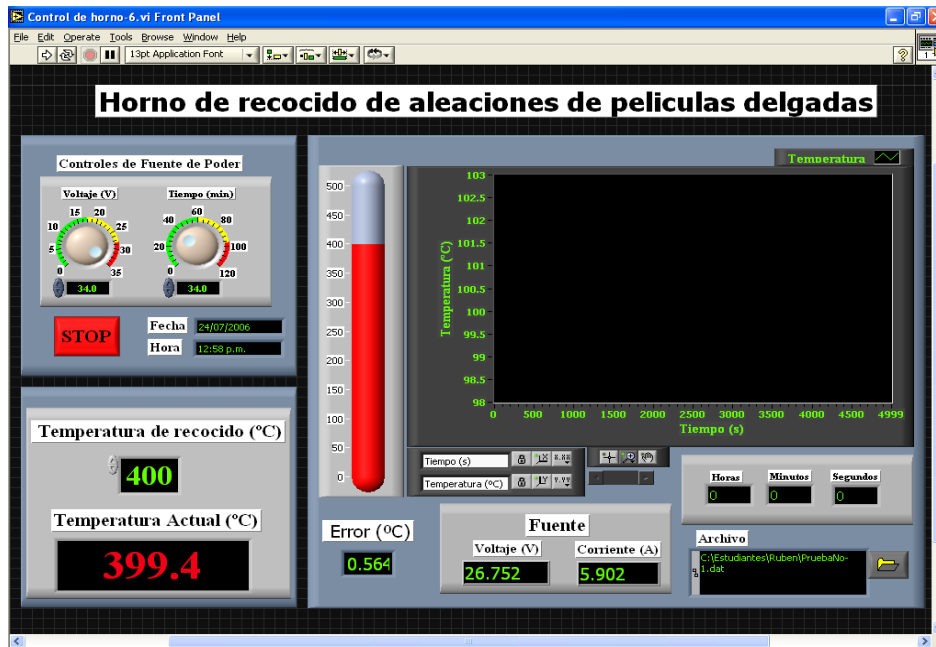
Figura A.4. Panel de control del horno para el recocido de las bicapas metálicas diseñada en LabView 7.0.
