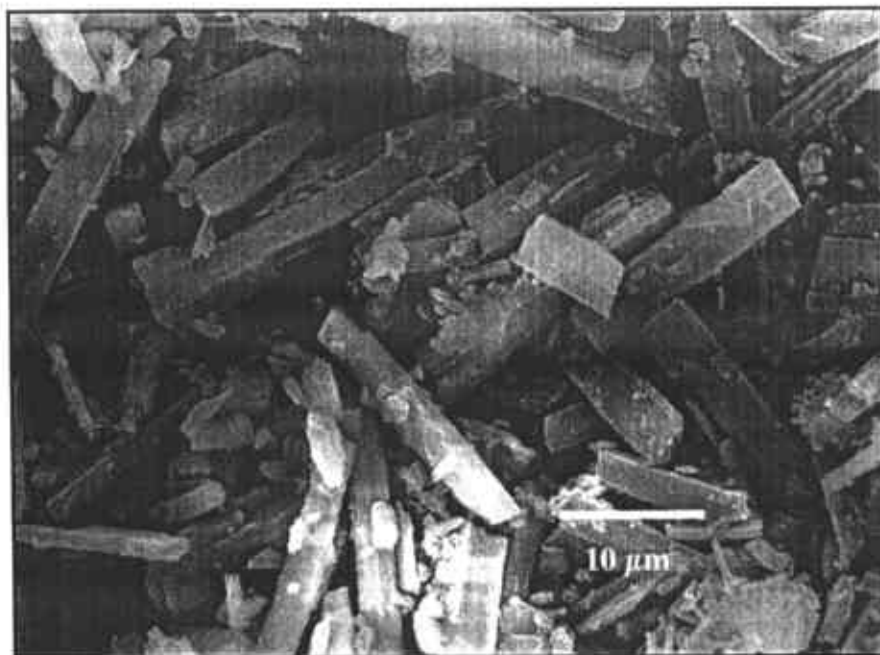
Figura IV.1.1.2. Micrografía de la morfología del acetil acetonato de circonio.
